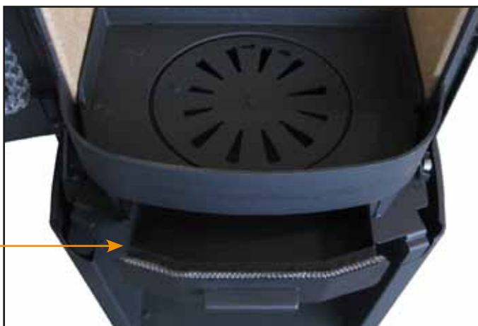
Figur 3 Fjern askeskuffen ved å trekke den ut og tøm innholdet
